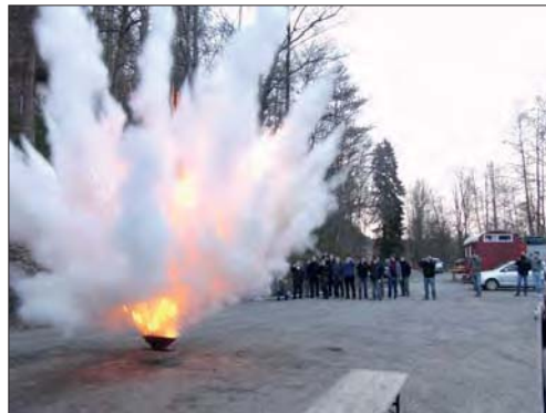
Über 170 Experimente im Lehrgang: Mehlstaubexplosion
